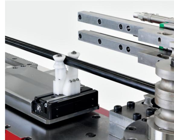
有时简单的就是最好的。可编程的自动对中管子支撑在需要时可支撑管子，用过之后快速移开。
