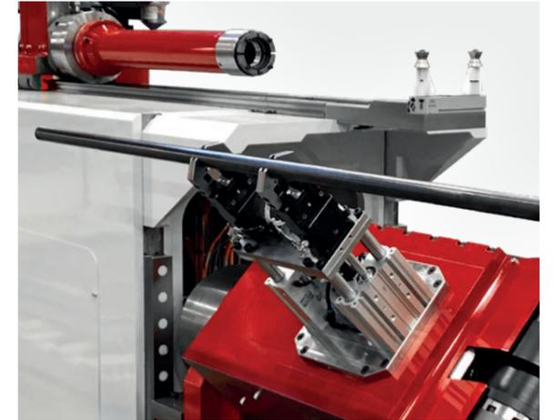
增加柔性 RL系列弯头上可配置上料夹手。自动上料简单几步设置即可完成。设备可实现的产品远比您对设备能力固有思维限制要多。圆的，扁的，椭圆和矩形截面的，没错，我们都可以弯。
