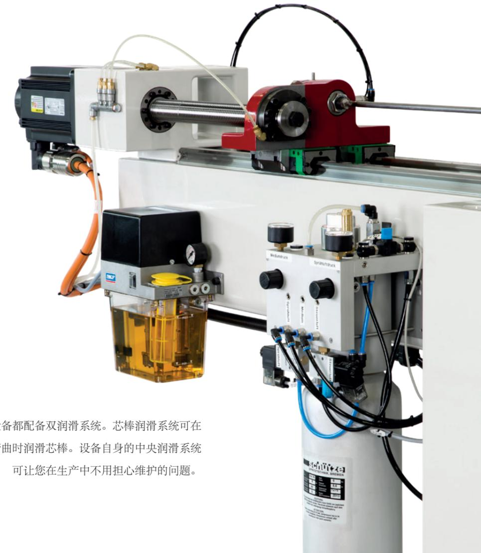
所有的设备都配备双润滑系统。芯棒润滑系统可在带芯棒弯曲时润滑芯棒。设备自身的中央润滑系统可让您在生产中不用担心维护的问题。
